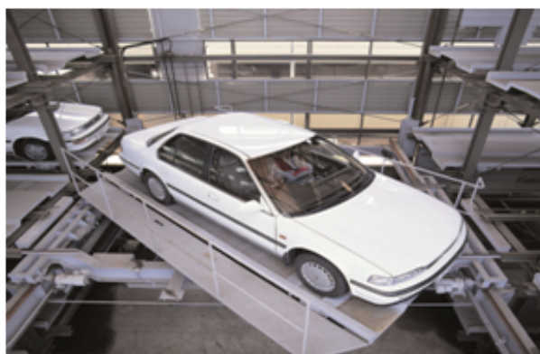
图7 升降横移类地下机械式停车场
