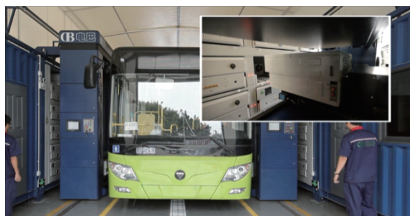
图8 集装箱模式的充换电站
