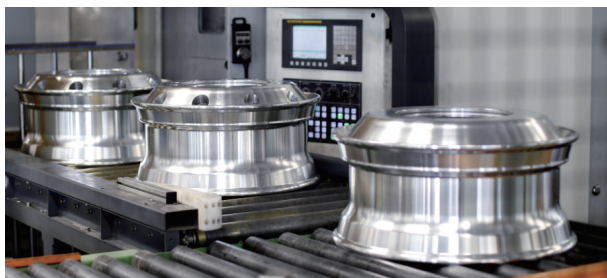
图 4 山东镁卡车轮有限公司生产的锻旋铝合金卡车轮毂
