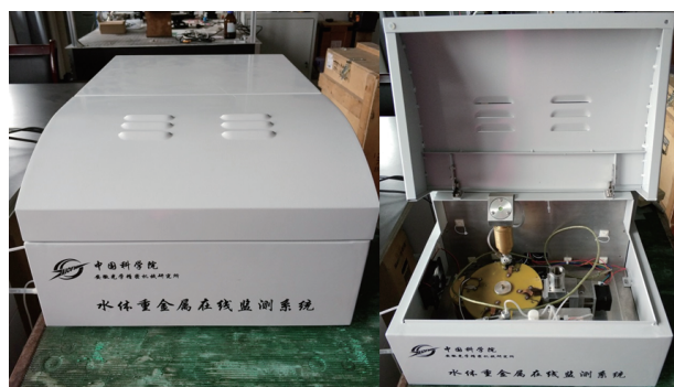
图 4 水体重金属在线监测系统
