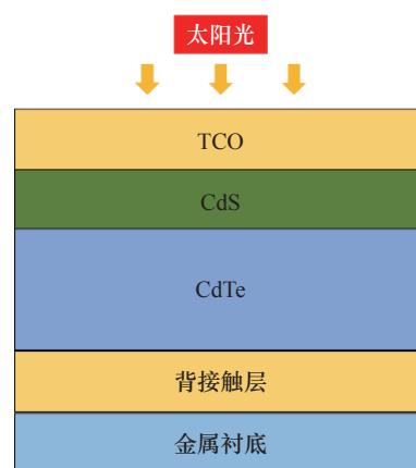
图 5 金属衬底柔性碲化镉太阳电池结构图
