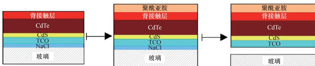
图 8 下衬底结构柔性碲化镉太阳电池制备流程图
