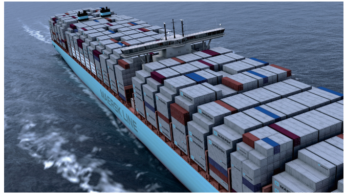
图 3. 3E 号货轮，新一代大型集装箱货轮的代表，长 400 m，宽 59 m，航速 19 节，载重吨位为 165 000 t。(http://www.maersk.com/en/search?q=Triple%20e&t=images, 12 February 2015)
