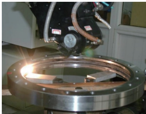
图 3 重载轴承的激光深层淬火
