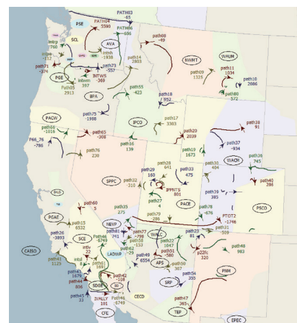
图 13. 假设的运行条件下 WECC 路径流量的可视化。
