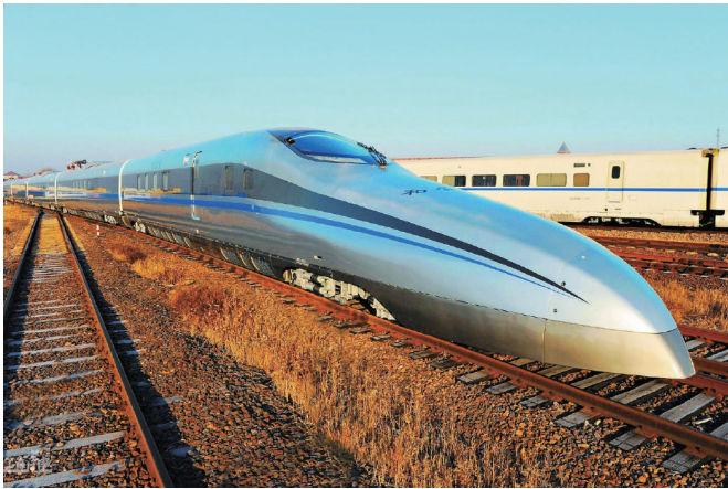
图3. 速度为 500 \text{ km} \cdot \text{h}^{-1} 的超高速列车的新测试模型。照片由中国中车股份有限公司提供。
