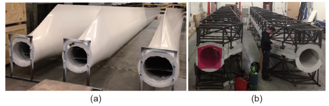
图8. 涡轮机叶片先进材料。(a) 长为13 m的单片式风力涡轮机叶片，适用于功率为250 kW的涡轮机；(b)使用玻璃/碳纤维和环氧树脂粉末通过电热陶瓷复合材料加工制成的叶片(图片由Conchúr Ó Brádaigh教授和ÉireComposites提供)。
