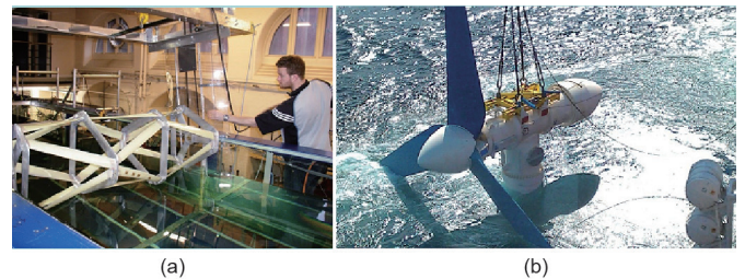
图6. 潮汐设备测试。(a) THAWT设备的实验室模型( http://www.kepler-energy.co.uk/ )[41]; (b) 欧洲海洋能源中心的1 MW潮汐设备的中试规模模型(图片Atlantis Resources Corporation提供)[42]。
