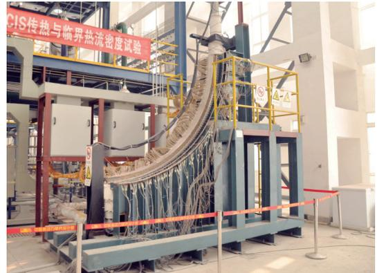
图6. 堆腔注水冷却系统(CIS)试验装置。
