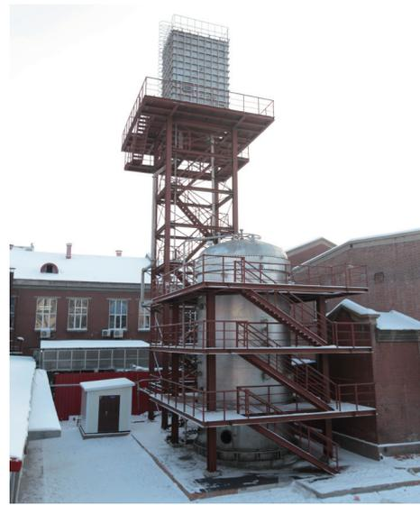
图8. 非能动安全壳热量排出系统(PCS)综合性能试验装置。
