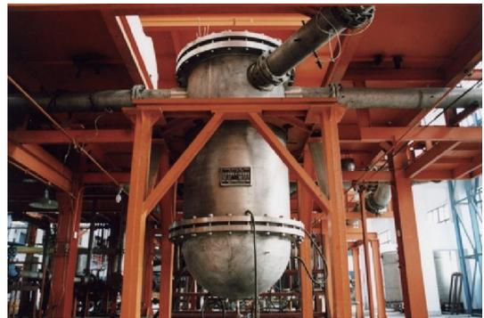
图9. 反应堆整体水力模拟试验装置。
