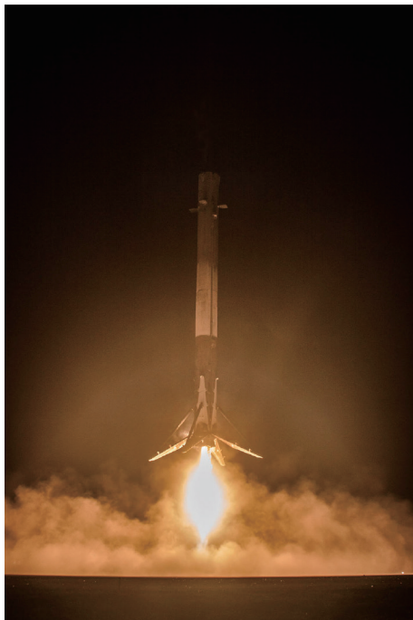
图1. 即将降落在发射台上的第一级火箭, 支腿部署在底部, 栅格尾翼部署在顶部以控制重返大气层时提升的方向。
