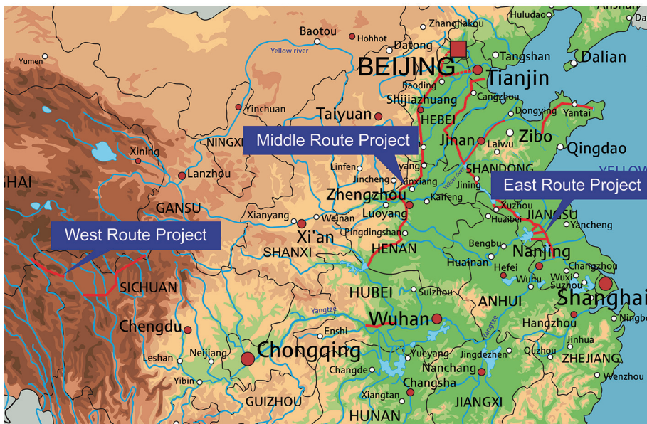
图11. 南水北调工程总体布局图
