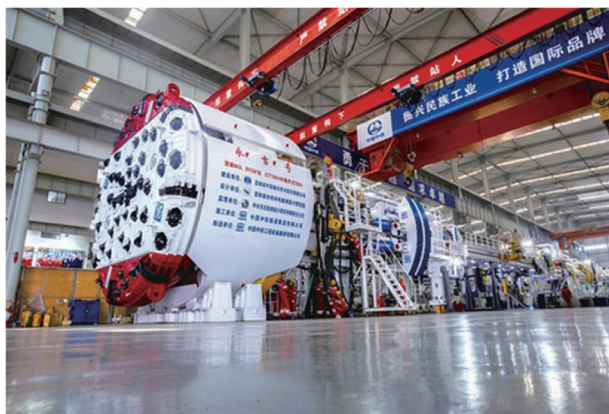
图12. 中国自主研制的8.03 m直径全断面岩石掘进机(TBM)。
