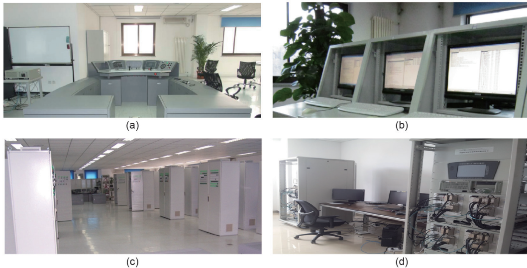
图4. 半实物仿真平台。(a) 司机台；(b) 仿真控制中心；(c) 车辆控制电气柜和信号处理电气柜；(d) 硬件在环测试。
