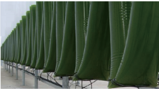
图1. 塑料袋式光生物反应器实例。
