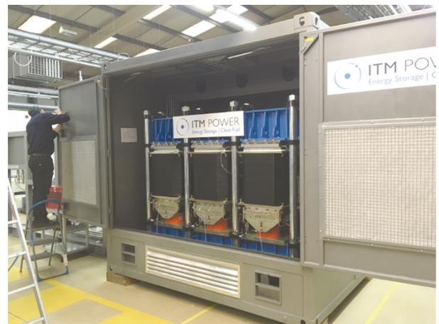
图3. 图为由ITM Power公司于2021年在其位于英国谢菲尔德的工厂建造的电解槽，该电解槽利用可再生能源将自来水分解为绿色氢气和氧气。来源：Wikimedia（CC BY-SA 4.0）。
