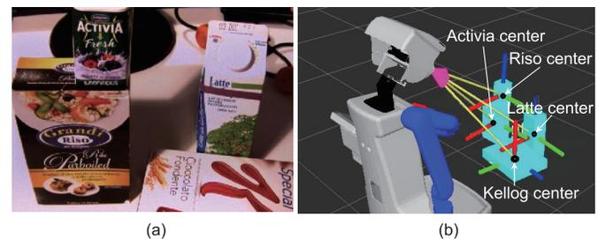
图 9. 对随机摆放的桌面物品进行识别。(a) 机器人头部摄像头视野中显示的摆放在桌面的若干盒装物品; (b) 通过 ROS Rviz 可视化工具显示出的物品识别结果。每一个被检测到的物品的名称、形状以及物品的 6 自由度位姿信息 (3 位置, 3 姿态参数) 通过 ROS 中 message 的形式发布出来。在该图场景中, 全部 4 个盒装物品通过 `Visionhub` 节点准确地检测、计算并发布出来, 通过 Rviz 显示它们的形状 (包围盒) 以及空间位姿 (图中红、绿、蓝轴构成的空间坐标系) 等信息。
