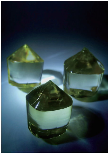
图 4. 提拉法生成的掺钕钷酸钷晶体。
