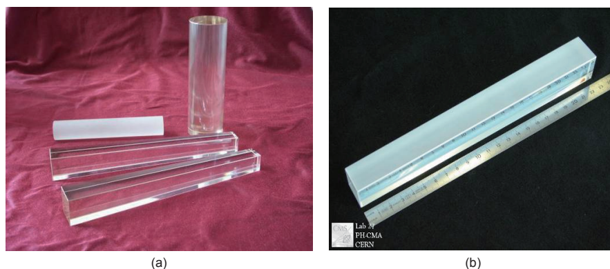
图 14. 高能物理学中用的 (a) 锗酸铋和 (b) 钨酸铅晶体。
