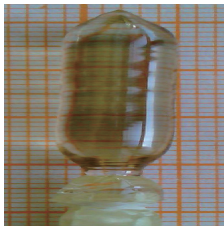
图3. 光学浮区法生成的掺钕氧化镱晶体。
