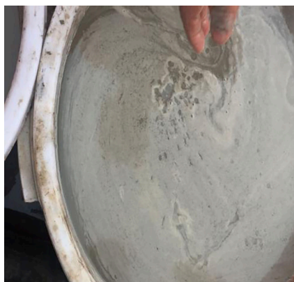
图1 南海珠江口盆地获取到的泥质粉砂水合物
