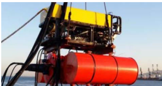
图5 ROV 携带水下抽油清污一体化机
