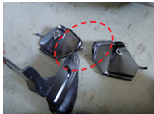
图32 改进前中央支架变形
