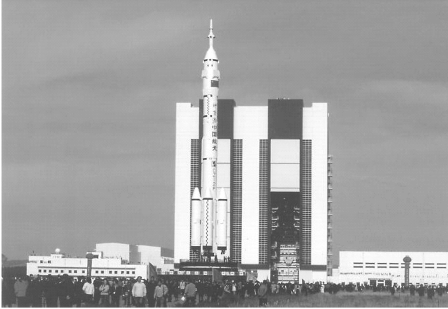
图 5 箭一船一塔组合体垂直整体运输
